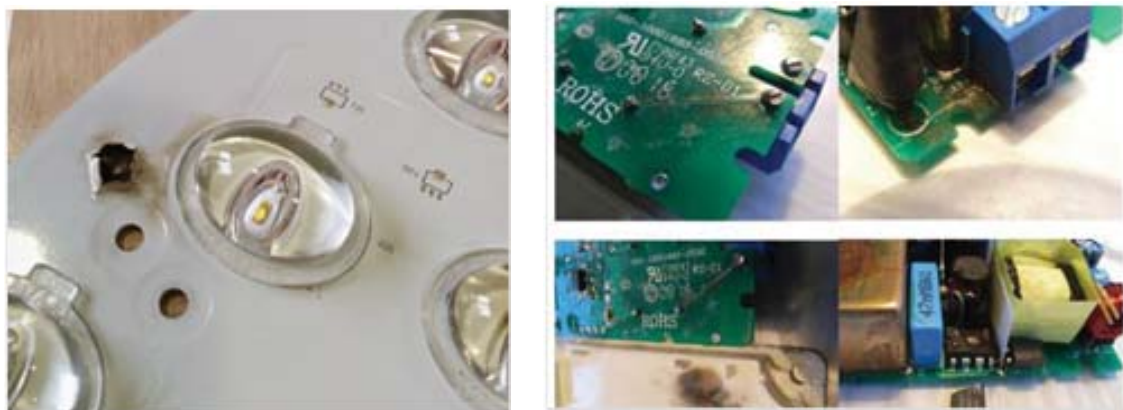
Примеры разрушения схемы LED и драйвера из-за перенапряжения, вызванного ударом молнии
